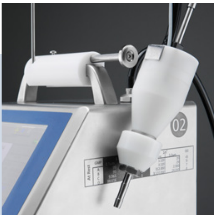
Partikelzähler SOLAIR 3100E mit Oberflächensonde DLS-20
