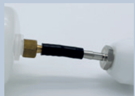
Alle Teile zusammenmontiert, um eine Nullmessung durchzuführen
