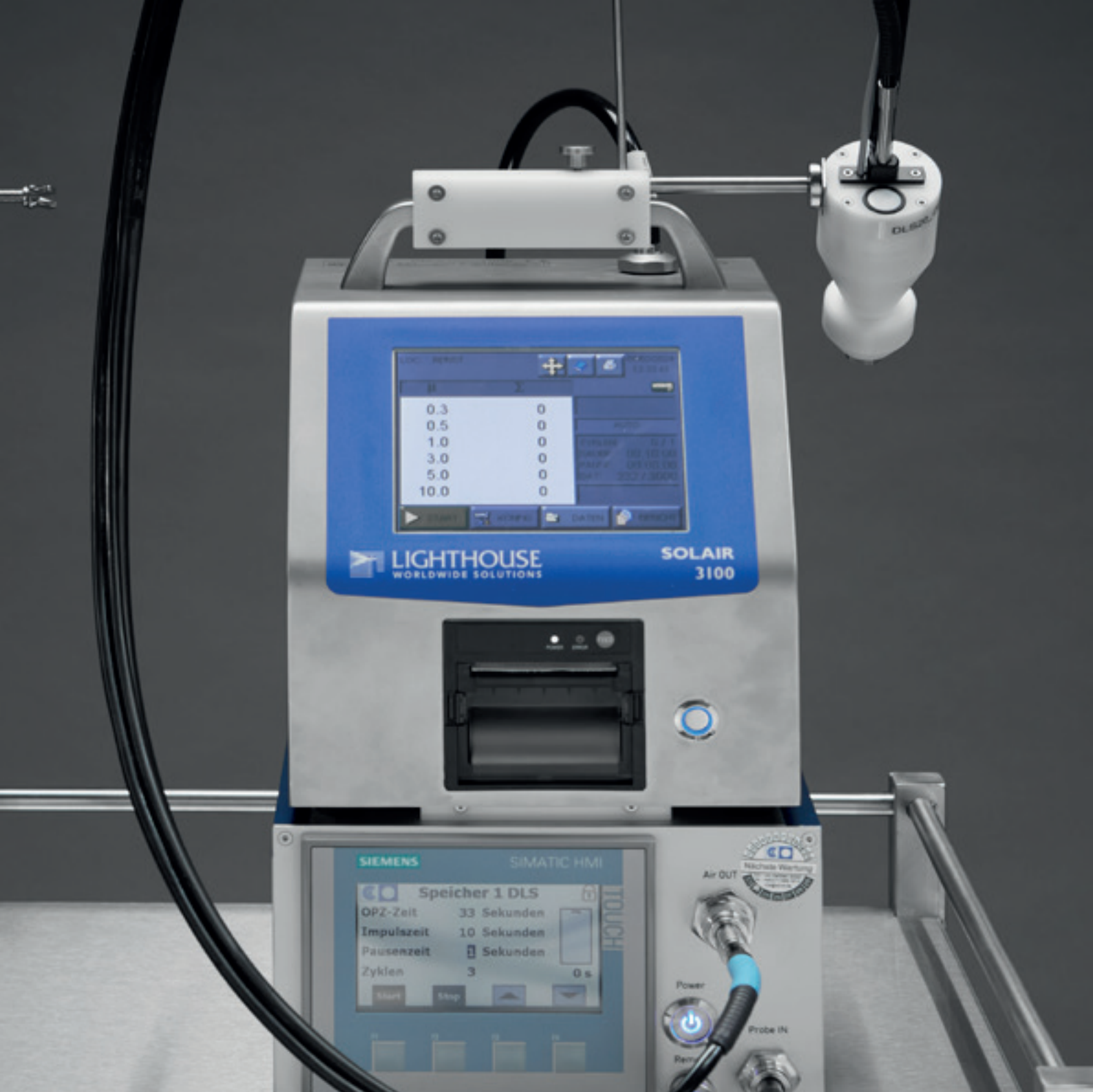
Partikelzähler Lighthouse SOLAIR 3100E montiert auf PCU-3-Steuerg r t mit Sonde DLS-20
