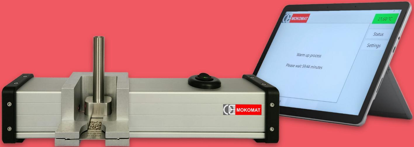
Messgerät Mokomat mit Steuer- und Auswerteeinheit //
