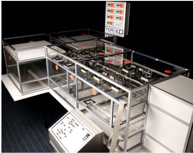
TCR: Training Clean Room Modellreinraum zu Übungszwecken
